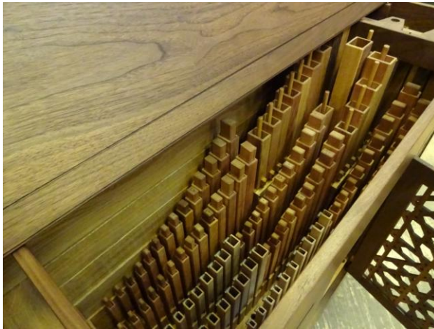
Órgano positivo construido en 2015 por Johan Deblieck, Bruselas. Un teclado manual C-d 3 . Mecánica de empuje. Toda la tubería en madera. 8'-4'-2'
